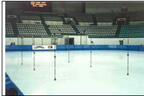
شکل (۳-۲) چارچوب کالیبراسیون نصب شده در زمین اسکی
