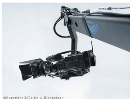
شکل (۲-۱) نمونه‌ای از نحوه اتصال دوربین به بازو در مکانیزم Camera Crane
