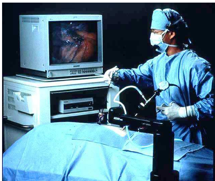
شکل ۲-۹. ربات ایساپ به عنوان نگهدارنده لاپاروسکوپ در جراحی MIS [27]
