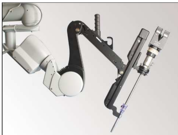
شکل ۳-۸. بازوی نگهدارنده لاپاروسکوپ در سیستم جراحی داوینچی [26]
