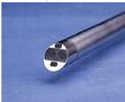
شکل ۲-۵. اندوسکوپ به کار رفته در سیستم داوینچی [26]
