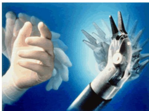
شکل ۲-۴. ابزار انتهایی مچی در سیستم جراحی رباتیک داوینچی [26]
