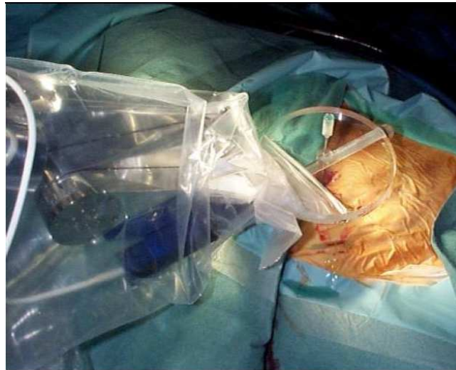
شکل ۱-۲. ربات RCM دارای مجری نهایی نامرئی در امواج تصویربرداری حین عمل جراحی استخراج سنگ کلیه [9]
