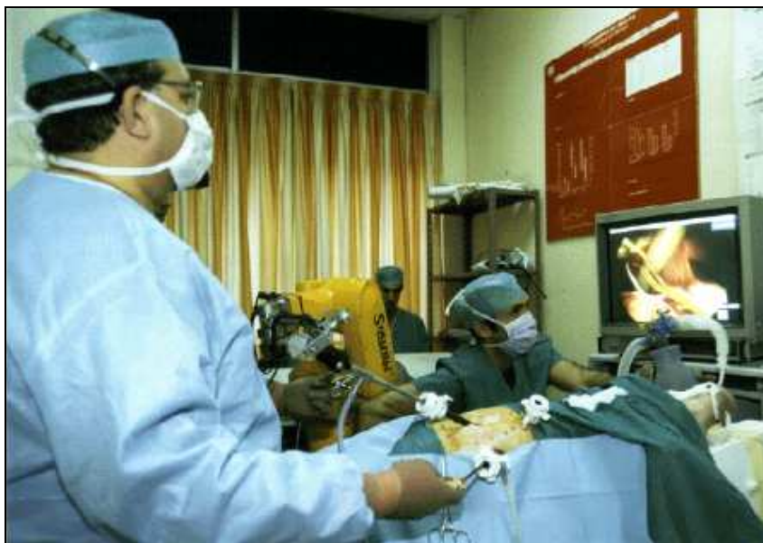
شکل ۳-۱۹. استفاده از ربات صنعتی Stäubli RX60 در جراحی لاپاروسکوپی [50]
