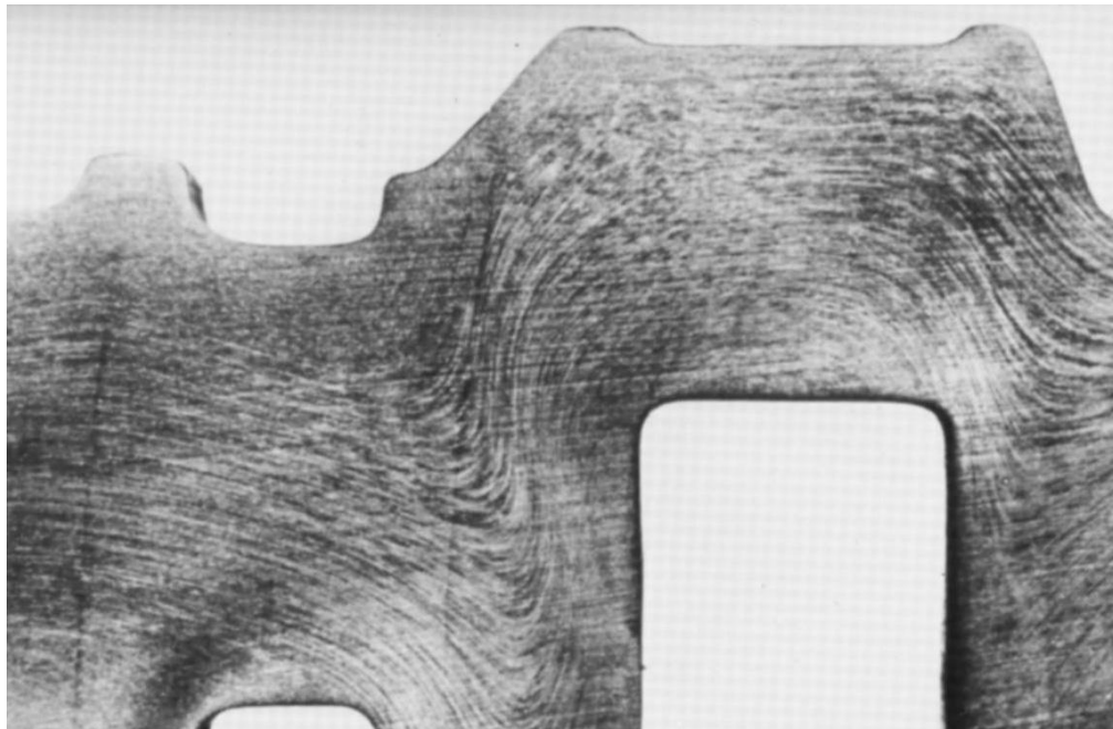
تصویر مقطع میل‌لنگ تولید شده به روش فورجینگ نشان‌دهنده جهت‌گیری دانه‌ها
