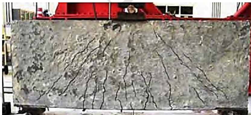
شکل ۴-۴: مدل آزمایشگاهی نمونه Control Beam [۴]
