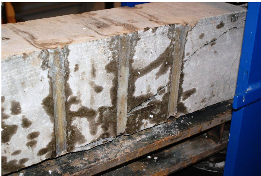
شکل ۳-۱۸ ترک خوردن و گسیختگی تیر NSMV10
