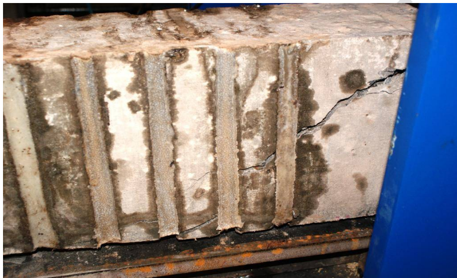
شکل ۳-۲۳ نمای شماتیک زاویه‌ی بین ترک برشی و میلگرد GFRP در تیر NSMIL10
