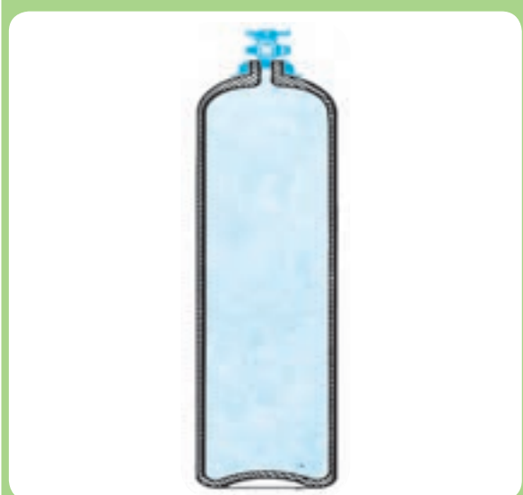
کپسول فولادی مخصوص برای ذخیره اکسیژن
