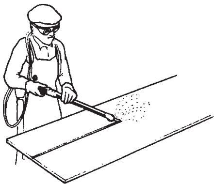
اجرای عملیات برشکاری با مشعل دستی
